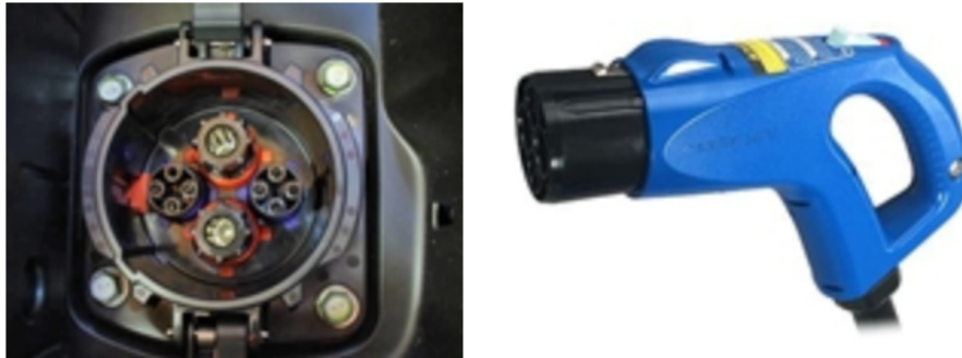
Figur 24. DC-kontakten Chademo för elbilsladdning (Garo, 2018)
